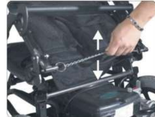
3. Tire de la cadena de la parte trasera del respaldo
