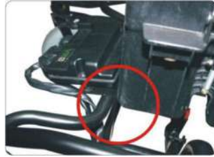
2. La caja de batería no puede tocar contra el polo del motor.
