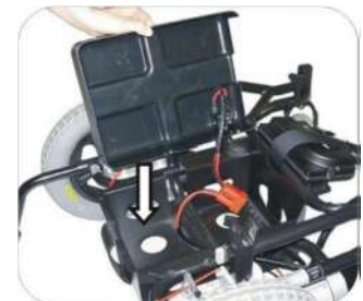
12. Después de sacar las baterías cierre la tapa de caja de baterías.
