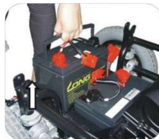
11. Levante la batería por sus agarraderas.
