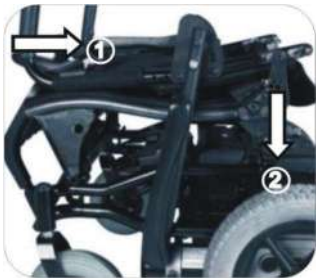
4. Pliegue el respaldo hacia delante y presiónelo.
