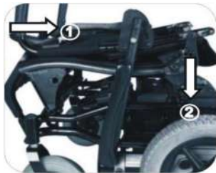
4. Pliegue el respaldo hacia delante y presiónelo.
