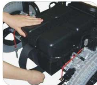
8. Desabroche el velcro de la base de la caja de baterías.
