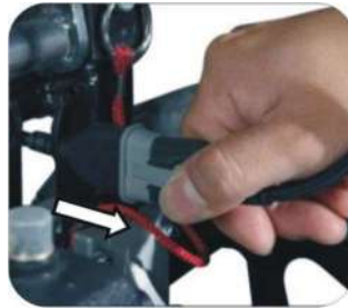
5. Desconecte el cable del conector de transmisión
