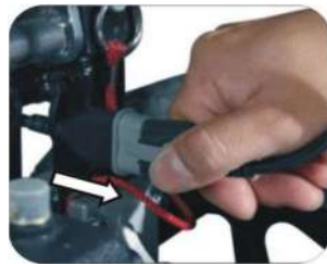
5. Desconecte el cable del conector de transmisión.
