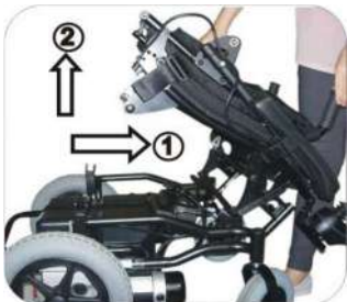
7. Tire del asiento hacia arriba y hacia delante para levantarlo.
